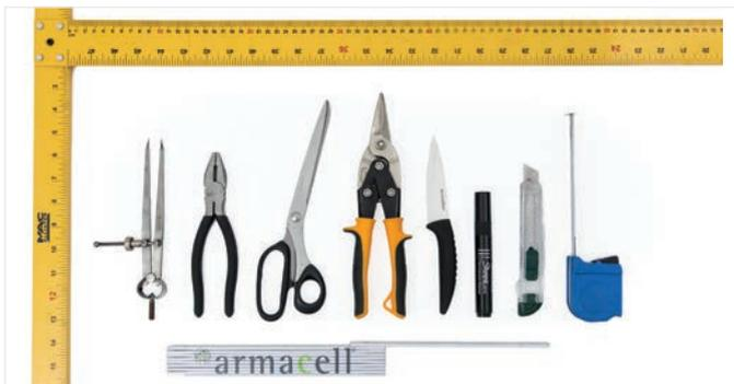
図5: ArmaGel HTの施工に推奨される工具
