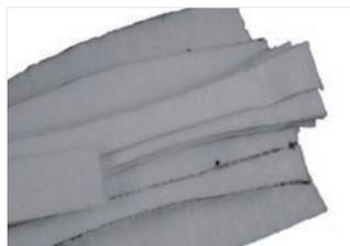
直線部分と接続部分用のパーツを事前に成形し、パレットに載せておくことができます。悪天候から保護してください。
