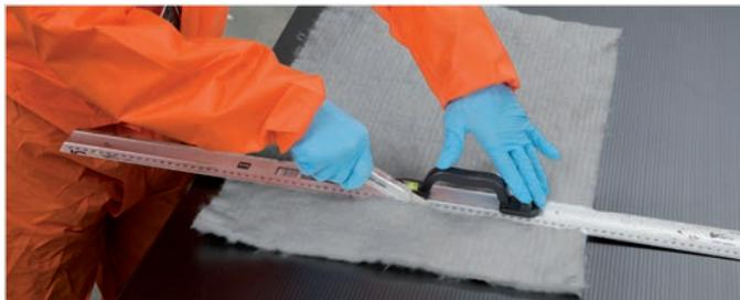
図4: プレハブ加工でのカット作業。
